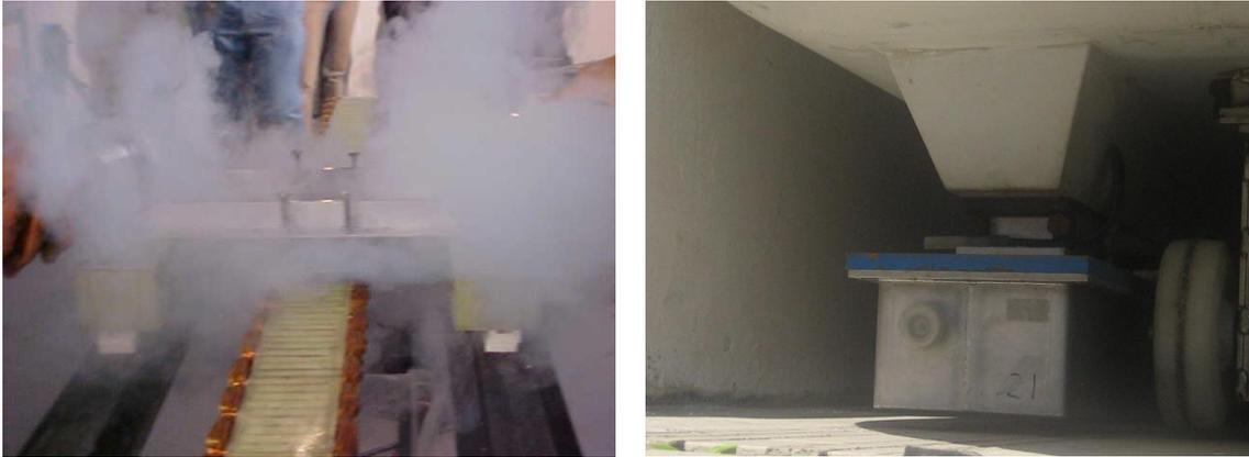
**Figura 22 - Fotos de testes com nitrogênio líquido no hangar do Bloco I-2000 e com o criostato integrado ao módulo operacional estacionado no CT 1.**
