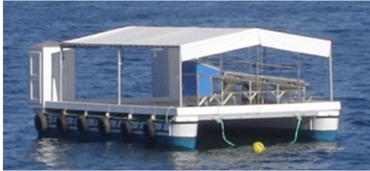
Figura 18 - Balsa Catamarã da Marine Equipment de 10m x 6m
