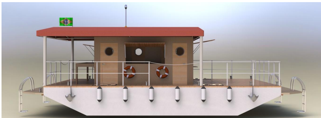
Figura 40 - Soluções C.1. e C.2: Toldo cobrindo uma área específica, e área fechada com paredes
