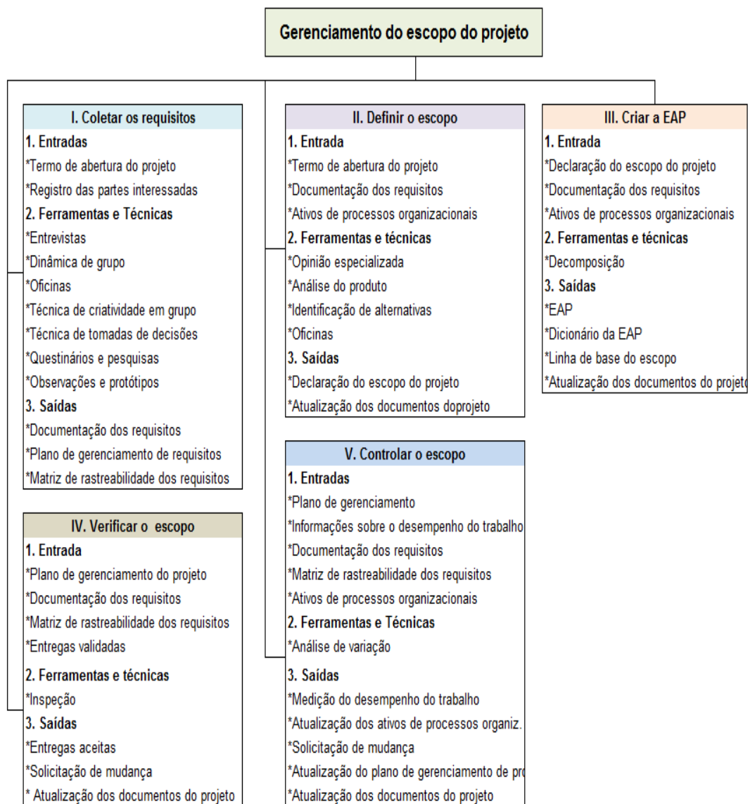
Figura 13. Visão geral do gerenciamento do escopo do projeto: entradas, ferramentas e técnicas, e saídas
