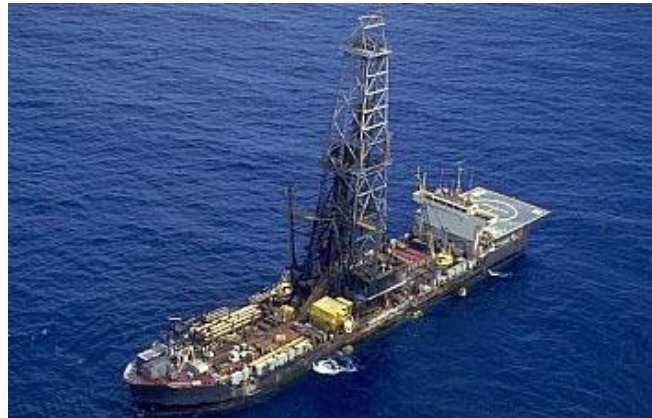
Figura 13 - Mastro de uma sonda marítima Fonte: ANP
