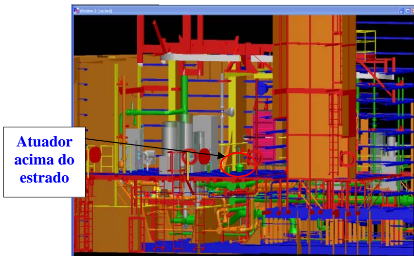
Figura 21: Ilustração, extraída do Modelo, da interferência entre o atuador e o estrado
