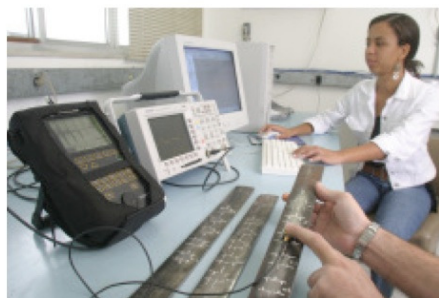
Ensaio de material com ultra-som.
