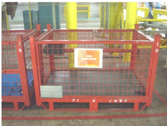
**Figura 14:** Gaiola vermelha disposta na linha de produção, destinada a peças refugadas
