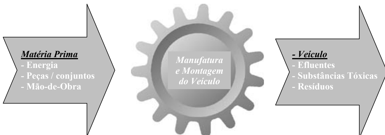
Figura 4. Entradas e Saídas na visão sistêmica de fabricação do automóvel. Elaboração própria do autor.
