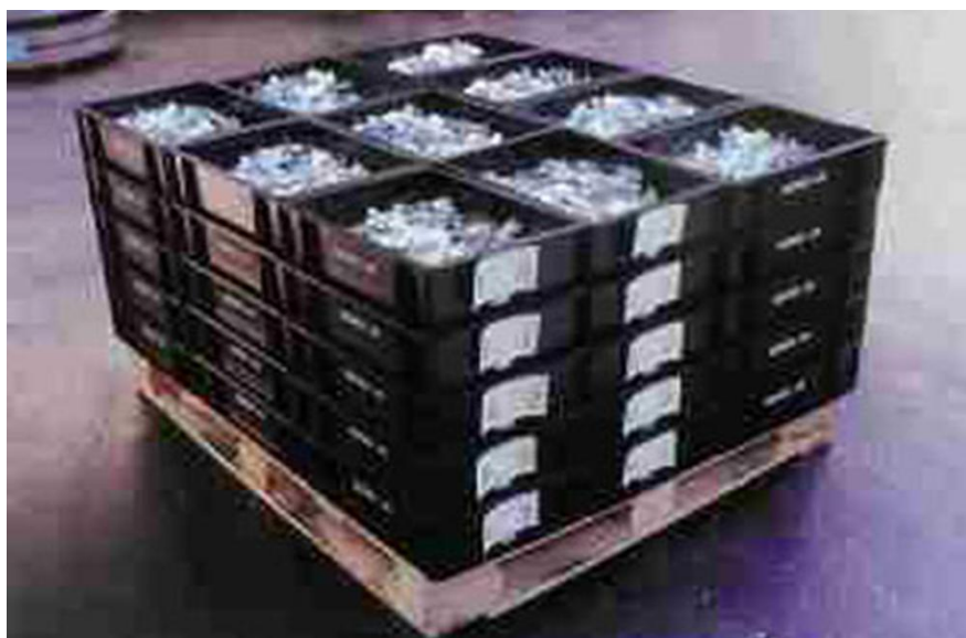
Figura 1: Exemplo de pequeno supermercado com o estoque organizado em contenedores e respectivos kanbans 2
