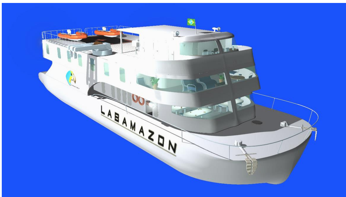
Figura 1 – Vista frontal em perspectiva. No alto, a cabine de comando; embaixo, no convés, a sala de estar. Ao nível do convés da proa, onde estão posicionadas as âncoras, o refeitório.
