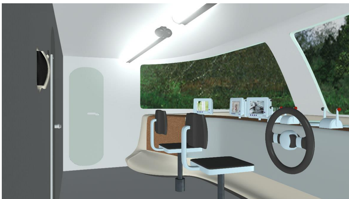
Figura 6 – Cabine de Comando. Capitão e seu auxiliar contarão com modernos equipamentos de navegação e comunicação, como rádios multifrequenciais, radar, ecobatímetro e sonar.
