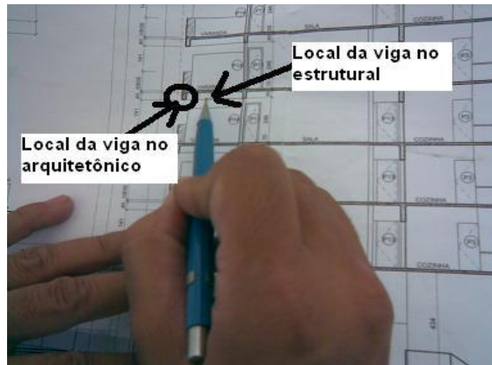
Figura 27 – Mostrando incompatibilidade no posicionamento da viga 25
