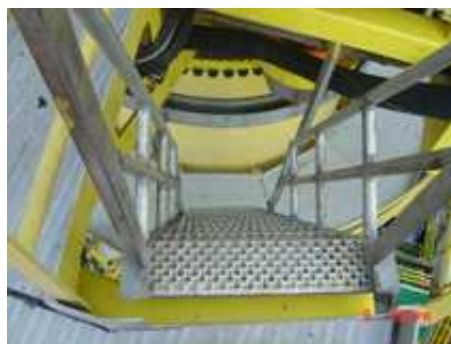
Figura 18 – Escadas com degraus estreitos
