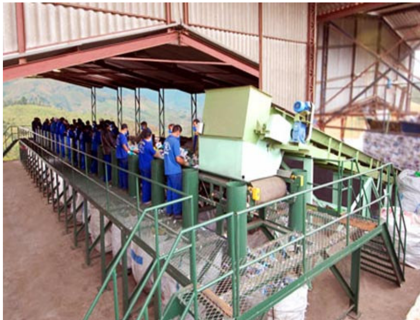
FIGURA 21: ESTEIRA DE SEPARAÇÃO DE 25m.
