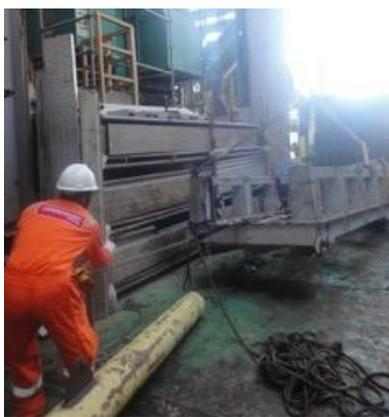
Figura 31 – Talha utilizada para evitar oscilações do *trolley* do permutador
