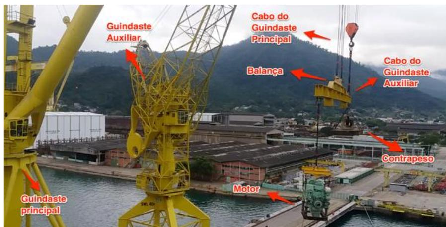
Figura 36 – Movimentação do motor do gerador utilizando balança com contrapeso
