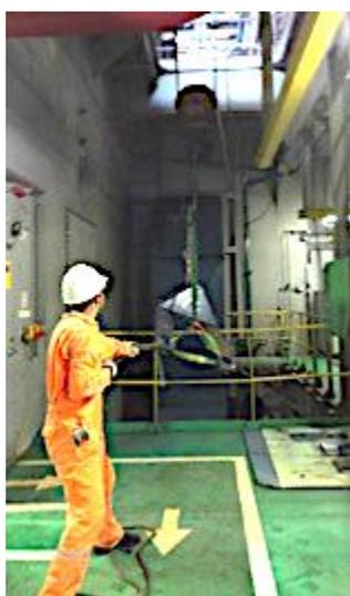
Figura 19 – Operador descendo com a paleteira pela gaiuta
