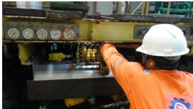
Figura 52 – Auxiliar verifica níveis de água e óleo do deck trolley
