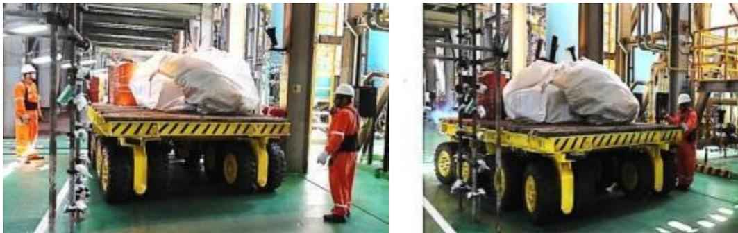
Figura 66 – Auxiliares orientam o supervisor, para passagem por andaime
