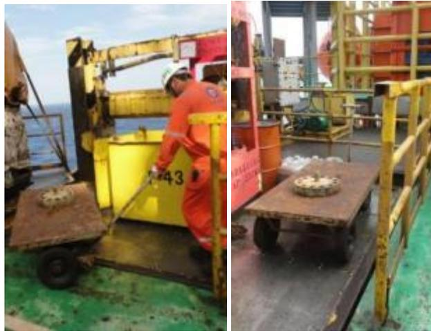
Figura 11 - Auxiliar realiza giro do carrinho e o coloca dentro do elevador de cargas
