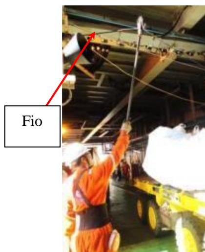
Figura 69 – Auxiliares utilizam vassouras para possibilitar passagem do *trolley*
