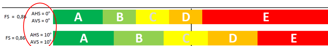
Figura 2.13: Evolução da classificação com a troca dos parâmetros AHS e AVS nos Edifícios 1 e 2 ( A_{pe} < 500m^2 ), mantendo inalterado o parâmetro FS
