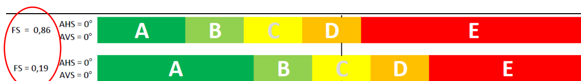
Figura 2.12: Evolução da classificação com a troca do parâmetro FS nos Edifícios 1 e 2 ( A_{pe} < 500m^2 ), mantendo iguais os parâmetros AHS e AVS
