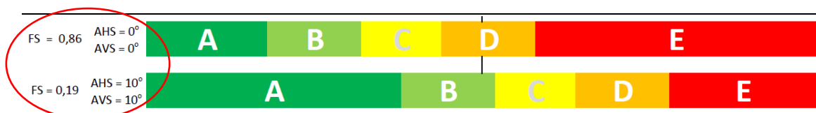
Figura 2.18: Evolução da classificação com a troca dos parâmetros FS, AHS e AVS nos Edifícios 3 e 4 ( A_{pe} > 500m^2 ) Fonte: Autor
