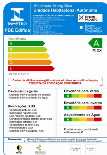
Figura 1.12: ENCE de Edificações Residenciais Fonte: BRASIL, 2012
