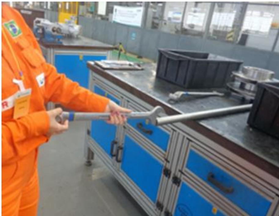
Figura 29 - Esquema de utilização do cano metálico e chave para construção da alavanca
