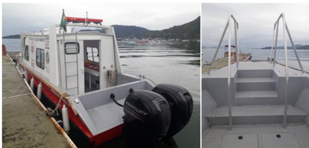
FOTO 4: Motores de popa e deck de proa da lancha de Paraty
