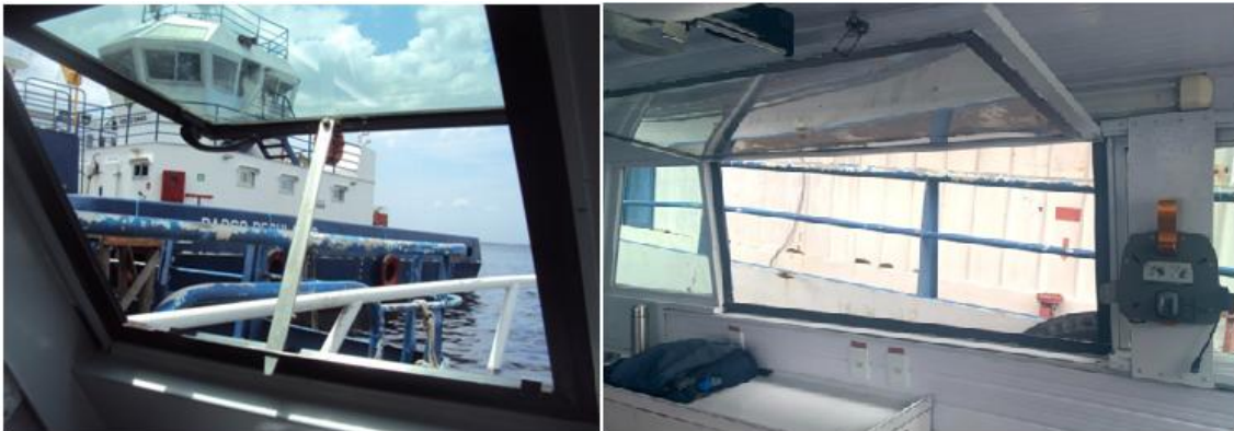
FOTO 30: O acesso do paciente à ambulância de Manaus é feito pelas janelas de proa e laterais, que se abrem perigosamente e já causaram acidentes
