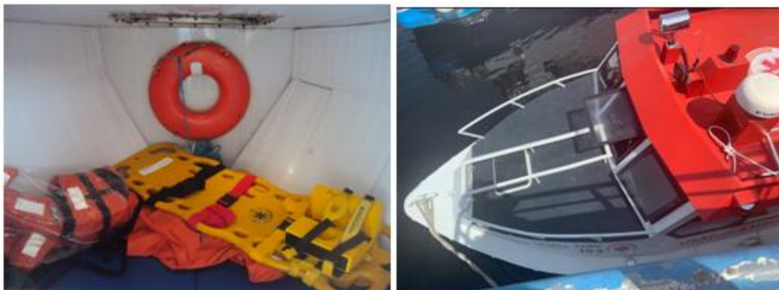
FOTO 19: Interior da proa e acesso do paciente pranchado pela janela de proa
