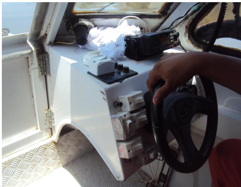
FOTO 39: Painel de comando em BC, sem instrumentos e de cor clara
