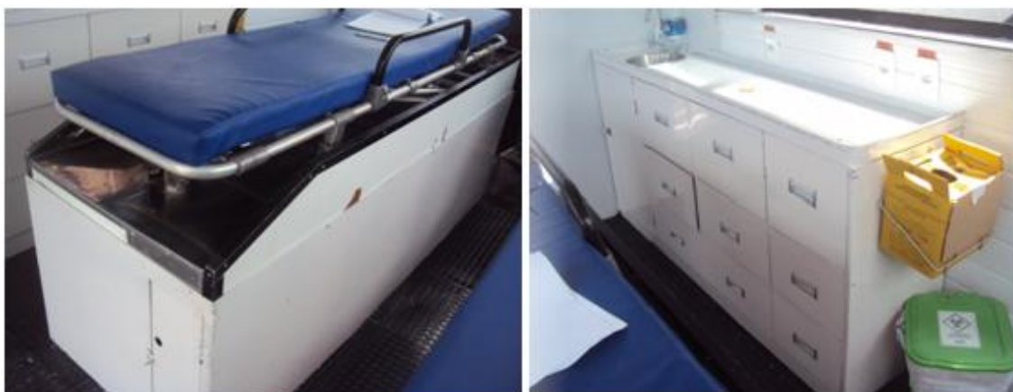
FOTO 20: Maca central removível e bancada com cuba e armários a boreste
