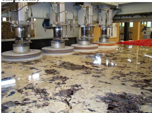
Do paginador as lâminas vão para o polimento, que pode ser automatizado onde uma máquina faz o processo de polimento liso e escovado ou por lixadeira manual.
