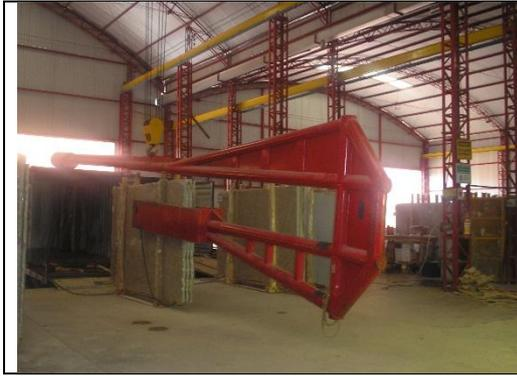
É realizado por dois operadores – um controlando a máquina de carregamento (bin laden ou ponte rolante) e outro dentro do container para preparar o acondicionamento das lâminas.
