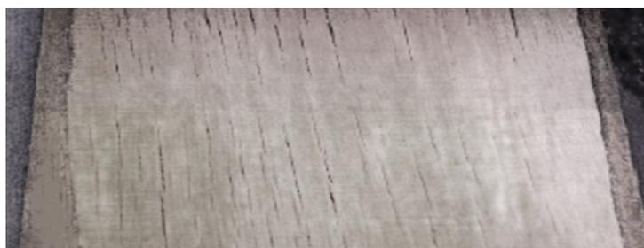
Figura 18. Defeito do tipo racha de superfície
