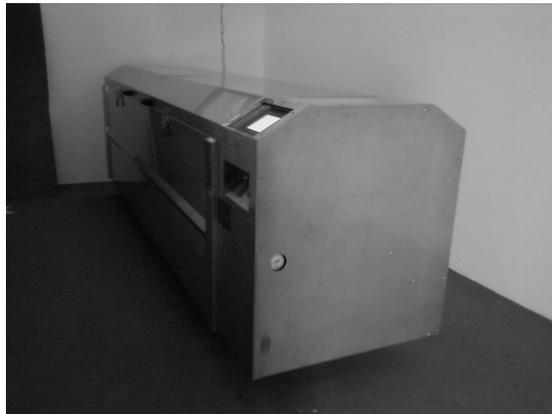
Figura 10. Forno de micro-ondas Easydry utilizado no experimento.
