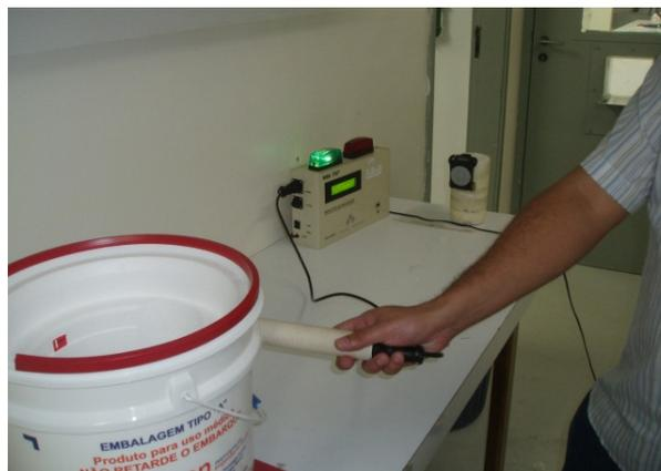
Figura 32: Medição do radiofármaco embalado em balde.
