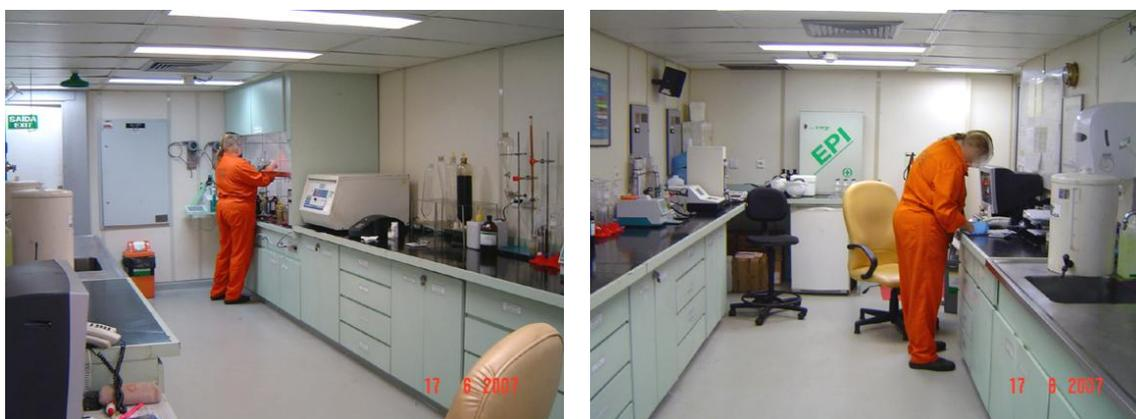
Figura 7 – Laboratório: capela, bancadas e estação de trabalho com computador no mesmo ambiente
